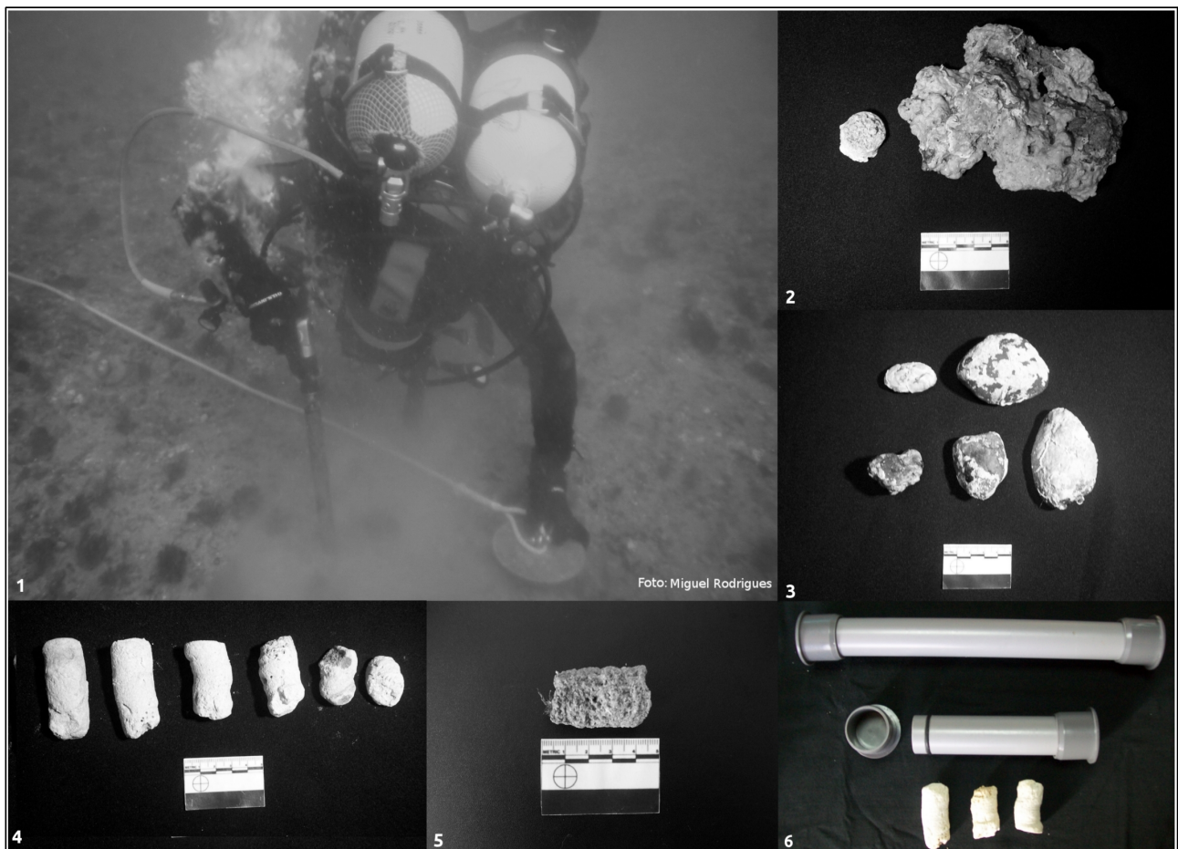
Figura 7: 1- Imagens dos trabalhos de amostragem, com o sistema pneumático desenvolvido acima, a 16 metros de profundidade; 2 (esquerda), 4, 5 e 6 (abaixo)- Amostras retiradas com o amostrador; 2 (direita), 3 - Amostras recolhidas a superfície; 6 – Case em PVC para a proteção da amostra obtida com o sistema pneumático de extração.
