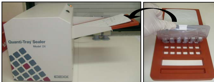
Fig. 10. Máquina selladora e inserto de goma, que permite distribuir el líquido en cada celda y sellar al vacío cada bandeja.
