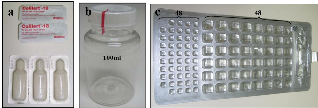
Fig. 8. a) Reactivo de Colilert-18 en polvo; b) Recipiente estéril que se utiliza para mezclar la muestra a analizar con el sustrato en polvo; c) Bandeja en que es vertida la muestra, y en la cual se realiza la incubación, pueden distinguirse los dos grupos de celdas de diferente tamaño, además de un pozo en la parte superior que sirve para coleccionar el excedente.
