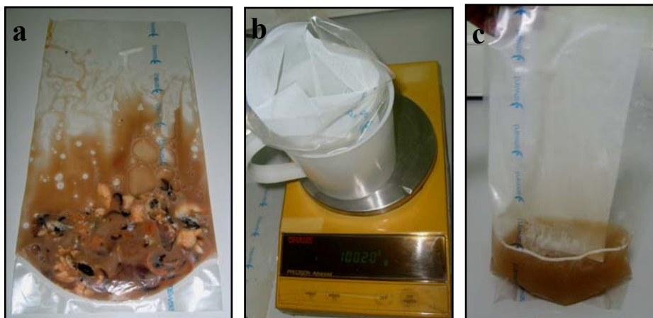
Fig. 4. a) Muestra de Mytilus spp en su primera homogeneización; b) Bolsa de homogeneización estéril donde se puede apreciar el filtro interior; c) Homogeneizado final de Mytilus spp que corresponde a la solución madre (dilución 10^{-1} ).
