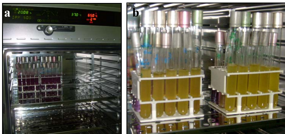
Fig. 6. a) Incubación de las series a 36\pm 1^{\circ}\text{C} por 24 horas; b) Después de la incubación es visible el viraje de color desde el lila oscuro característico del medio de cultivo hacia amarillo que identifica los tubos positivos que finalmente indican la presencia de coliformes.
