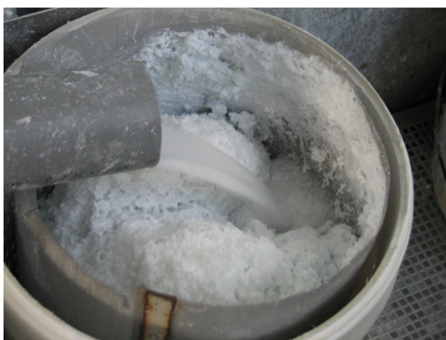
Figura 11 – Imagem do reservatório que recebe as aparas resultantes do corte das lentes.
