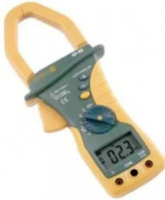
Figura 0.21 - Pinça Multimétrica – Koban KP 90*
