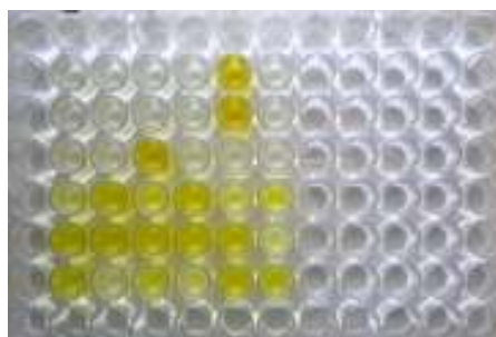
Figura 13. Imagem da microplaca transparente de 96 poços, com a mistura reaccional que permitiu avaliar a inibição das enzimas AChE e BuChE ex vivo .
