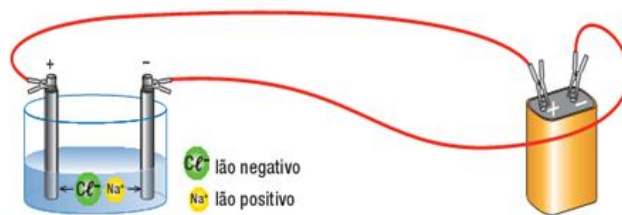
Figura 1.51. Iões na solução boa condutora.
