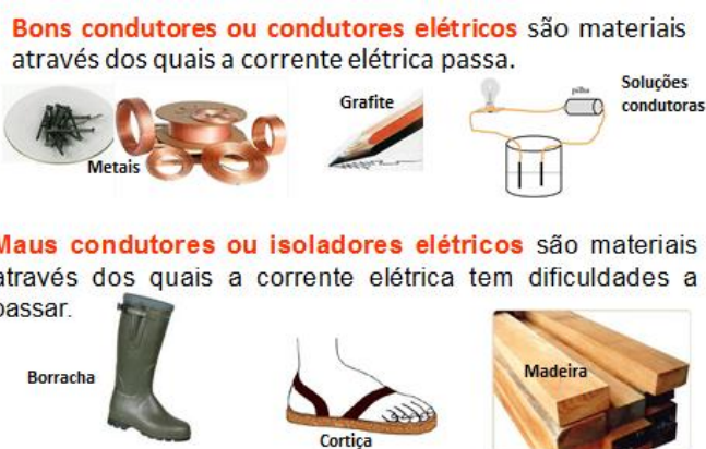
Figura 1.52. Materiais bons e maus condutores de corrente elétrica
