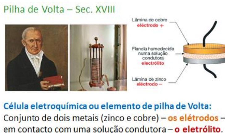
Figura 1.53. Elemento de pilha de Volta.
