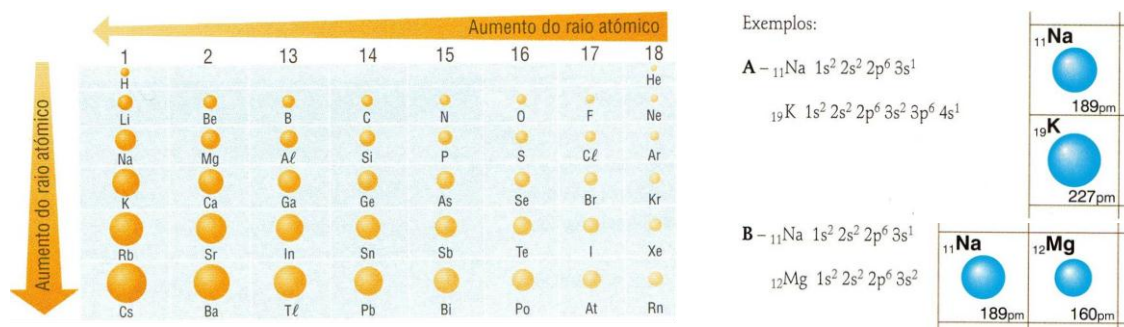
Figura 1.30. Variação do raio atômico nos elementos representativos.
