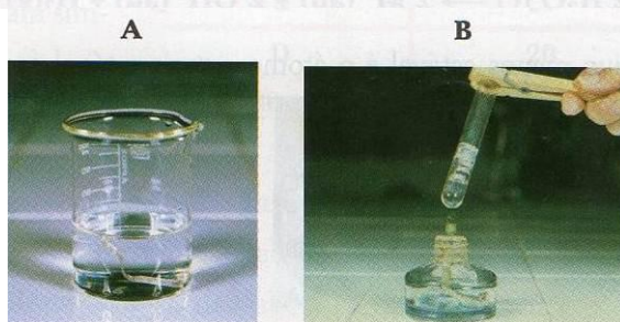
Figura 1.42. Reação do magnésio a frio (A) e a quente (B).
