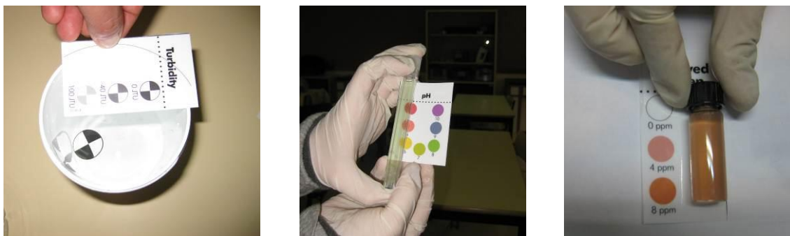
Figuras 1.61, 1.62 e 1.63. Alguns parâmetros analisados: turbidez, pH e oxigênio dissolvido nas amostras de água.
