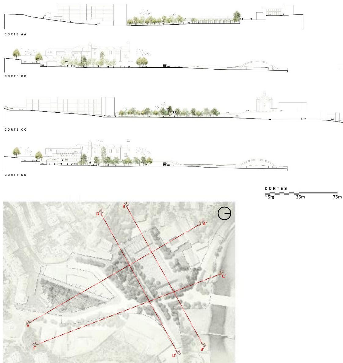
Figura 91 - Cortes para concurso com indicação de localização – Proap (ver à escala (Escala vertical - 1:200, Escala horizontal -1:1000) em anexo)
