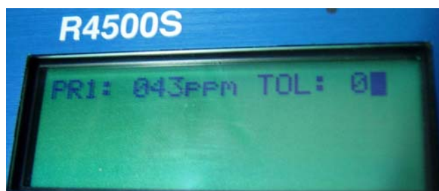
Figura 30 – O número de impulsos por minuto e a tolerância da recepção dos sinais.
