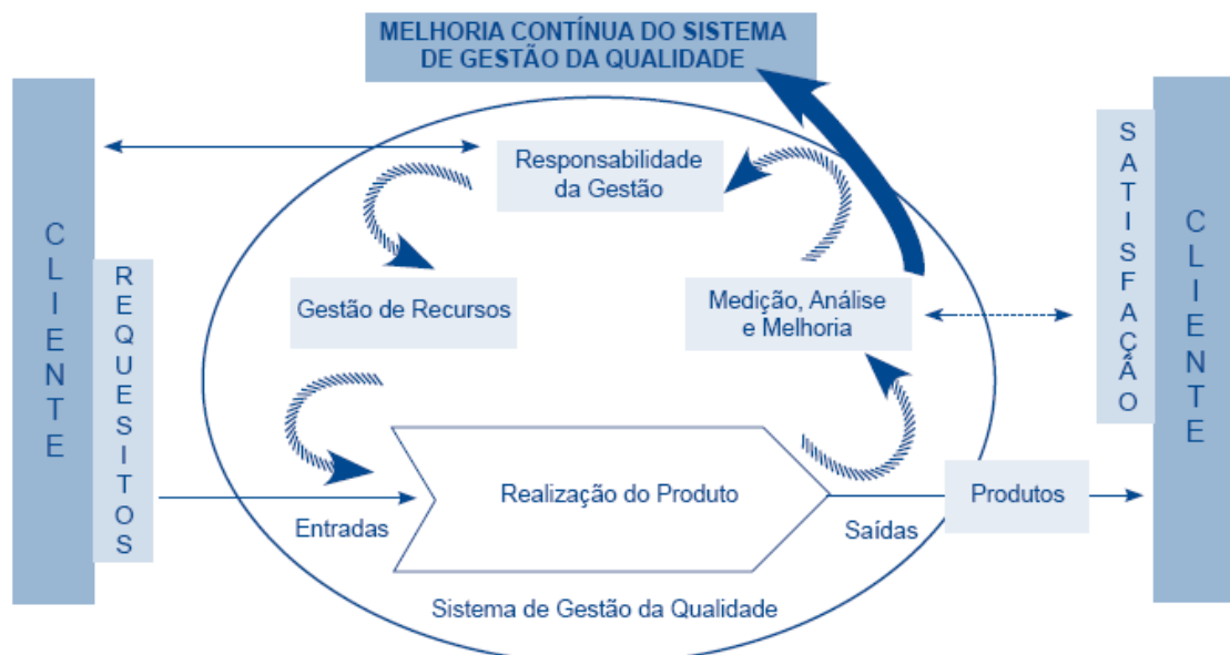
Figura 1.11 – Modelo de um sistema de gestão da qualidade baseado na norma ISO 9001:2000
