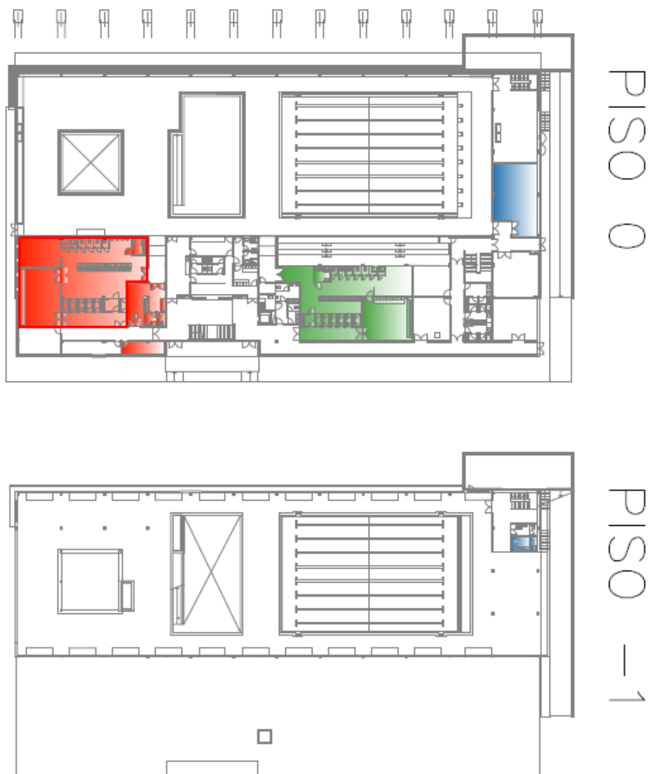
Figura 47 – Zonas climatizadas pelas unidade de tratamento de ar (a vermelho UTA H, a verde UTA M e a azul UTA J).
