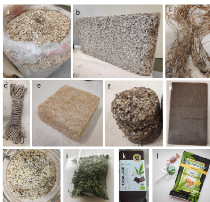
Figura 4.1 – Alguns produtos feitos de cânhamo-indiano ((a)- casca de cânhamo; (b)- cânhamo; (c)-fibra de cânhamo; (d)- corda material de isolamento; (e)- material de isolamento; (f)- placas para aquecimento; (g)- plástico para impressão 3D; (h)- semente de cânhamo; (i)- chá; (k)- chocolate; (l)- rebuçados). Adaptado de: (4)
