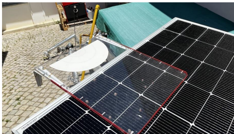
Figura 32 - Equipamento para regulação da inclinação do painel fotovoltaico em relação à altura solar
