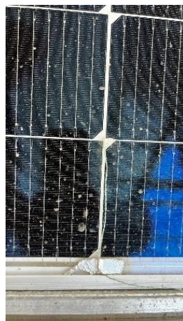
Figura 38 - Termopar de medição da temperatura na base da superfície de incidência solar do painel fotovoltaico
