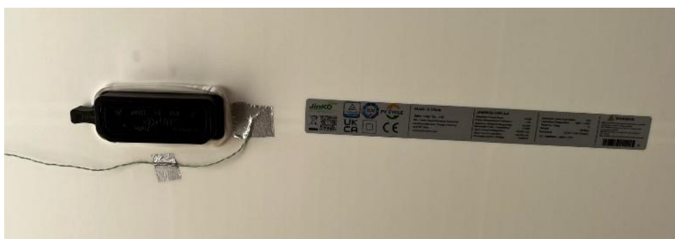
Figura 39 - Termopar de medição da temperatura no centro da superfície interior do painel fotovoltaico
