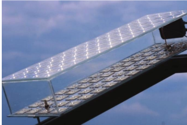
Figura 19 – Dispositivo concentrador solar em forma de lupa, (figura retirada de https://www.researchgate.net/figure/Figure-2-A-CPV-solar-cell-module-Fresnel-lens-array-is-used-to-focus-sunlight-onto_fig39_325618123 ).
