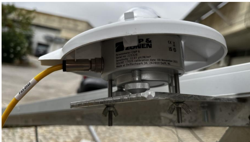
Figura 34 - Piranômetro utilizado na medição da radiação solar (exemplo demonstrado no plano do painel)
