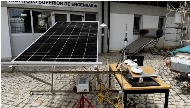
Figura 33 - Atividade de estudo do painel fotovoltaico em curso, com os diversos equipamentos de medição e leitura, bem como estrutura com inclinação regulada para estar num ângulo de estudo definido
