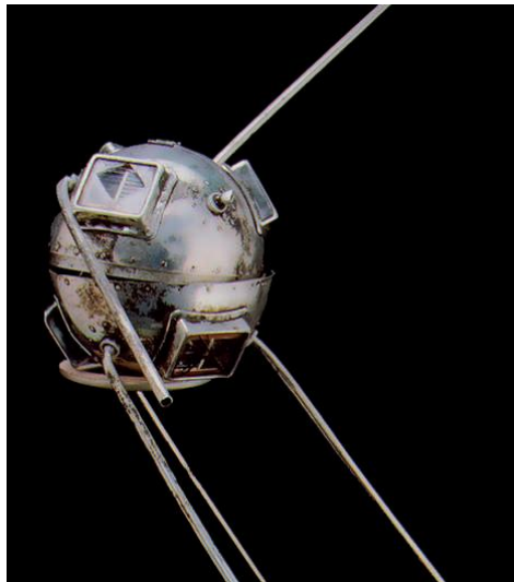
Figura 13 – Imagem do Vanguard I, o primeiro satélite com células solares, lançado em Março de 1958 levando a bordo um pequeno painel solar com 100 cm 2 visível na janela em cima à esquerda, (extraído da referência [3]).
