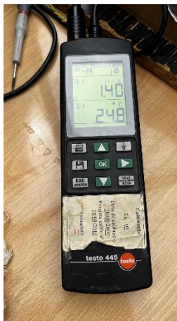
Figura 41 - Equipamento de leitura e recolha de dados de velocidade do vento e de temperatura ambiente
