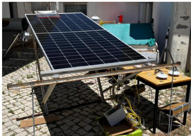
Figura 27 - Atividade de estudo do painel fotovoltaico em curso, com os diversos equipamentos de medição e leitura, bem como estrutura com inclinação regulada para estar num ângulo de estudo definido
