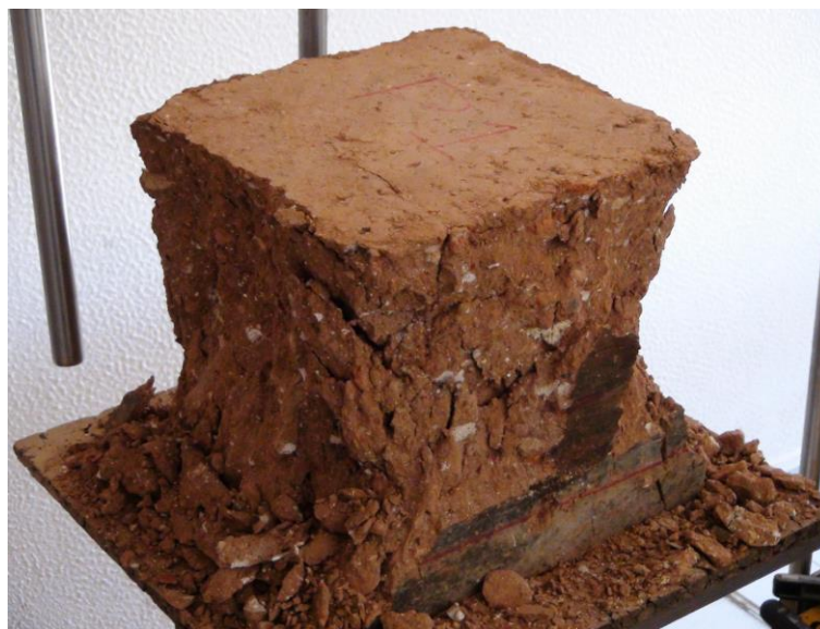
Figura 2: Ensaio de um cubo de taipa à compressão (200×200×200 [mm]).
