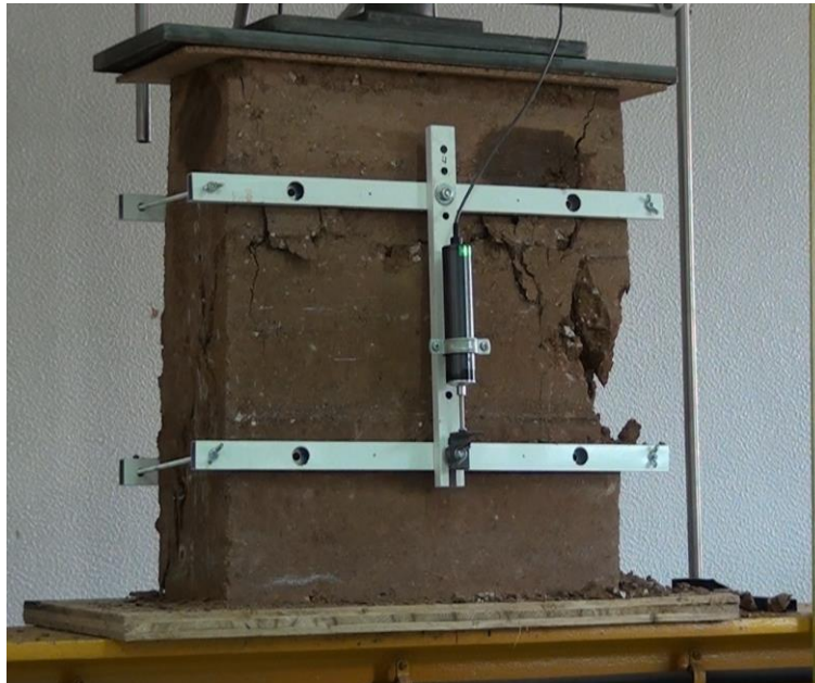
Figura 3: Ensaio de um provete de taipa à compressão (200×500×600 [mm]).
