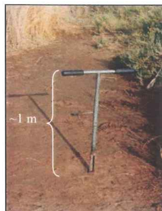
Figura 7 – Instrumento de recuperação de testemunhos de sondagem – meia cana.
