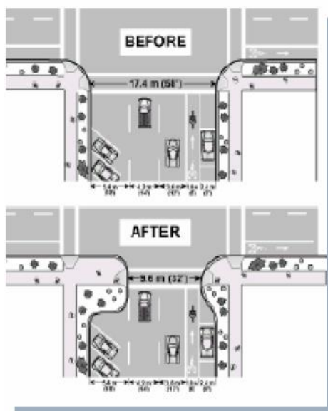
Fig XIII. Alargamento dos passeios nas travessias
