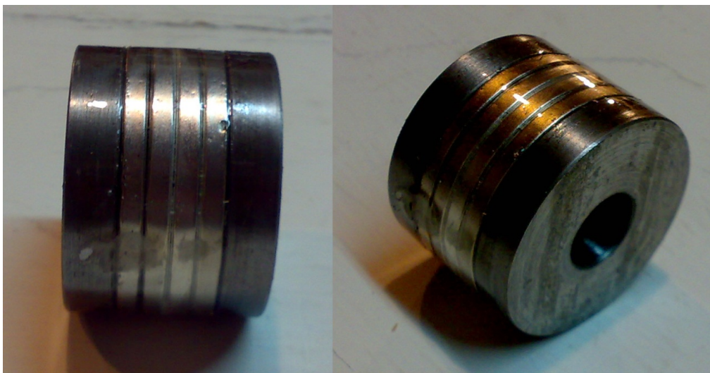
Figura 5.4 – Conjunto do sistema de excitação da máquina eléctrica terminado (após secagem da cola).
