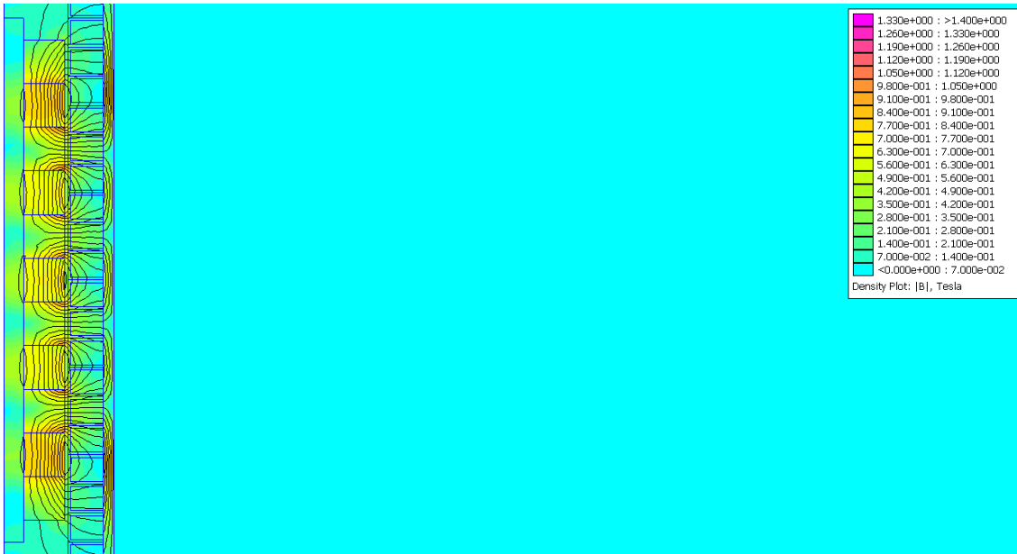
Figura 2.21 – Distribuição da densidade de fluxo e linhas de fluxo na máquina eléctrica.
