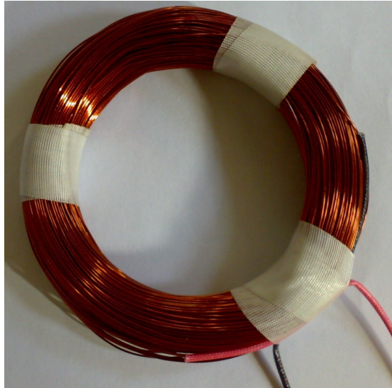
Figura 5.12 – Bobine da máquina eléctrica.
