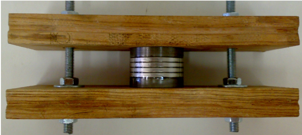
Figura 5.3 – Prensagem de um bloco do sistema de excitação para secagem da cola.
