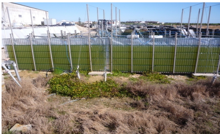
Fig. 6 - Fotobiorreactor do tipo “Green Wall” utilizado no decorrer deste trabalho no exterior
