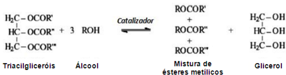
Fig. 2 – Reacção de transesterificação para triacilgliceróis (adaptado de Demirbas, 2009)
