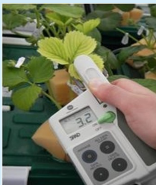
Figura 3. Medição dos valores de SPAD-502 (Minolta).
