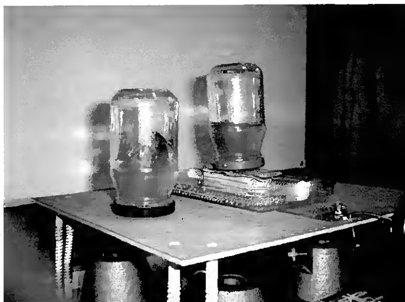
Figura 43: Um dos frasco (e o seu conteúdo) está isolado das oscilações da mesa pois está colocado sobre a plataforma anti - vibração – a superfície livre do líquido mantém-se horizontal. No outro frasco, colado sobre a mesa, pode-se observar as oscilações na superfície livre do líquido.
