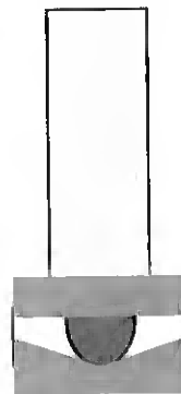
Figura 21: O pilar assenta numa base com alguma liberdade para se mover na horizontal pois, as superfícies envolvidas foram planificadas de modo a ter pouco atrito na zona central. No Aeroporto Internacional de São Francisco, construído para resistir a sismos de magnitude 8, utilizou-se este sistema de protecção anti-sísmica. Imagem retirada de: www.ideers.bris.ac.uk
