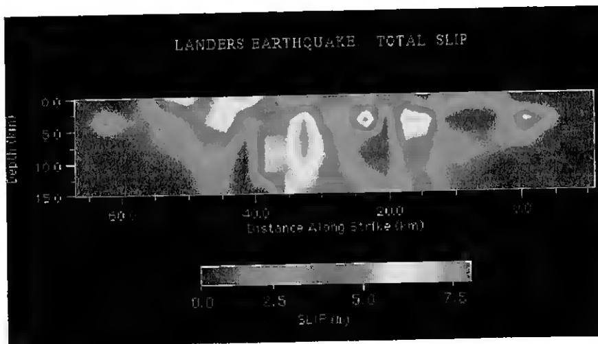
Figura 16: Sismo de Landers, Califórnia; 1992; Magnitude 7,3. A distância ao longo da falha foi medida a partir do foco. O deslocamento máximo ocorreu a cerca de 33km do foco (a vermelho na figura). www.scecdc.scec.org/Mpegs/lanmap/mpg
