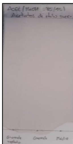
Figura 2.14 Análise qualitativa da pureza do acetato de etilo recolhido na primeira coluna cromatográfica. Foi utilizado como eluente a mistura acetato de etilo:metanol (85%/15%).
