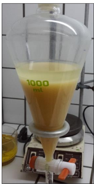
Figura 2.4 Extração líquido-líquido do Ensaio 1. A fase orgânica encontra-se em cima e a fase aquosa em baixo.
