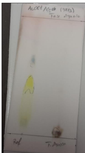
Figura 2.11 TLC da primeira extração líquido-líquido do ensaio preliminar. Do lado esquerdo da placa, foi aplicado o composto de referência (phlomispurpentaolone) e do lado direito, foi aplicada uma amostra da fase aquosa.
