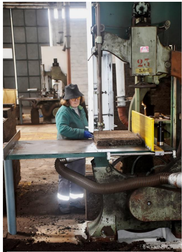
c) Em caso de acidente, causado por falha de segurança, ou operação inadequada, este, pode resultar em consequências severas (no caso amputação ou outros ferimentos graves).
