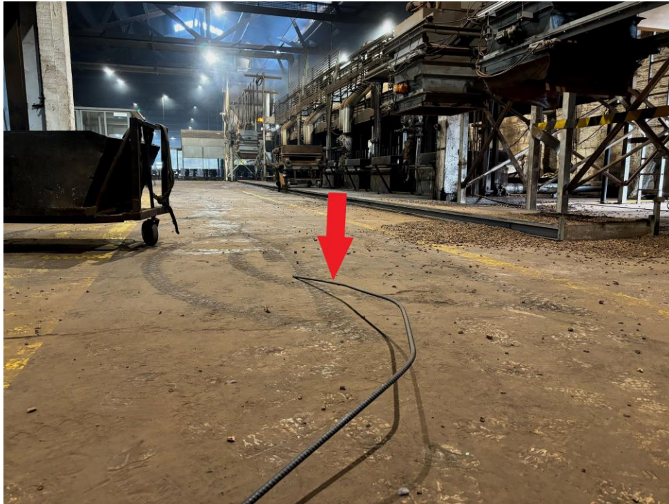
a) Posto de Trabalho ‘Autoclaves’. Objetos “largados” no chão.
