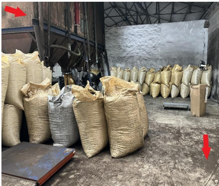
b) Posto de Trabalho 'Regranulados'. Riscos de Ordem e Limpeza.
