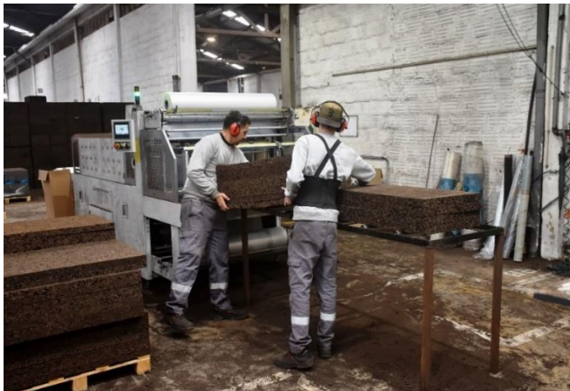
b) Colaboradores colocando as placas de aglomerado na máquina que procede ao embalamento.
