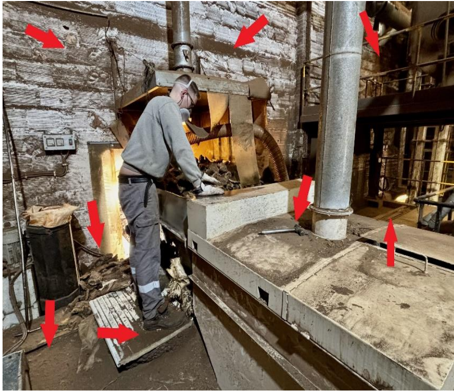
a) Posto de Trabalho 'Trituração'. Riscos de Ordem e Limpeza.
