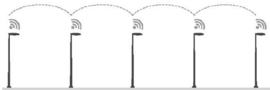
Figura 3.29: Exemplo de funcionamento wireless entre luminárias [19]
