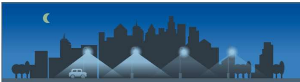
Figura 3.27: Exemplo de funcionamento de um sistema de telegestão com sensores de movimento e direção [19]
