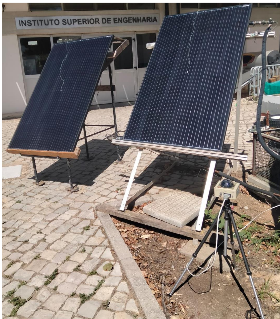
Figura 3.10-Fotografia da instalação dos dois painéis e do piranómetro
