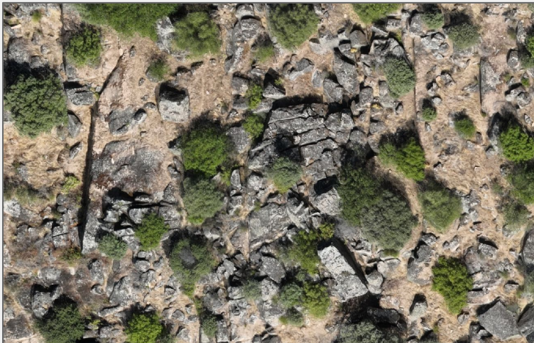
Ortofotomosaico em formato TIFF e com 3 centímetros de resolução.
