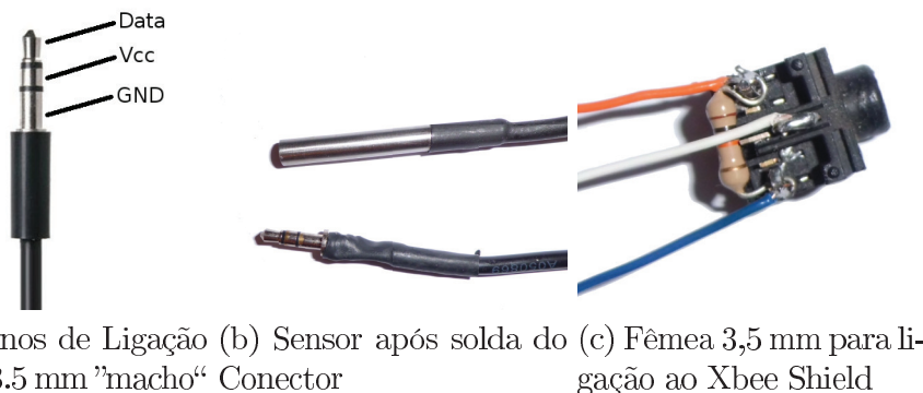
Figura 4.3: Demonstração do processo de ligação da ficha para conexão do sensor de temperatura ao protótipo.
