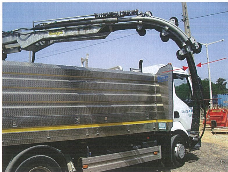
Figura 2.23 – Viatura Desobstrutora da rede de águas residuais
