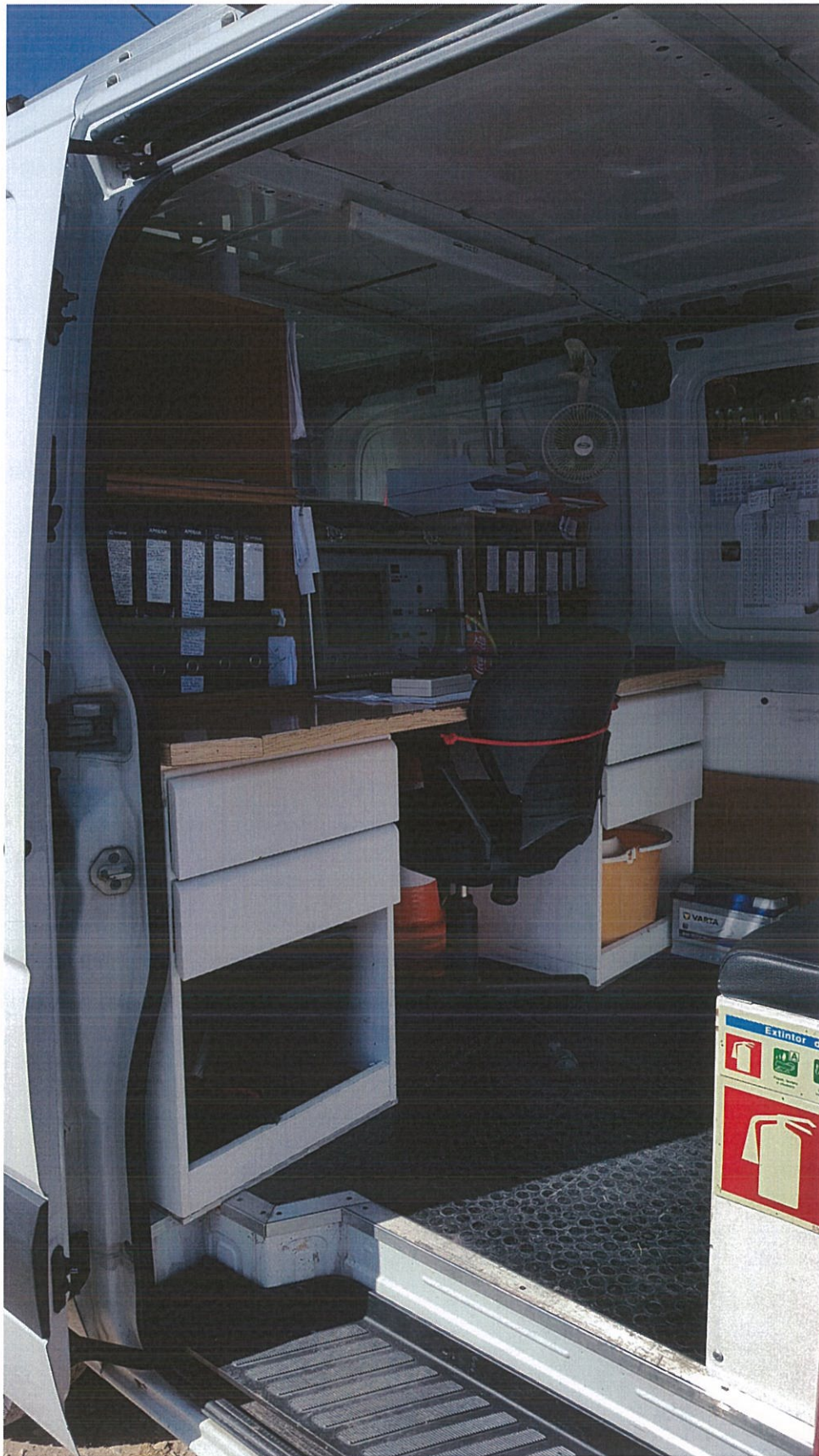
Figura 2.46 – Interior da viatura transformada em espaço de comando do robot
