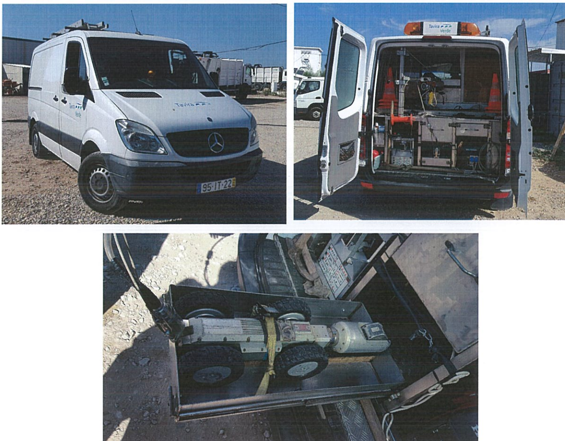
Figura 2.45 – Viatura de inspeção vídeo e respetivo robot
