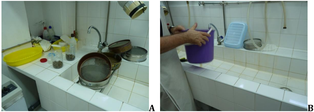
Figura 42 – Crivagem. A – Crivos utilizados; B – Agitação da amostra em água
