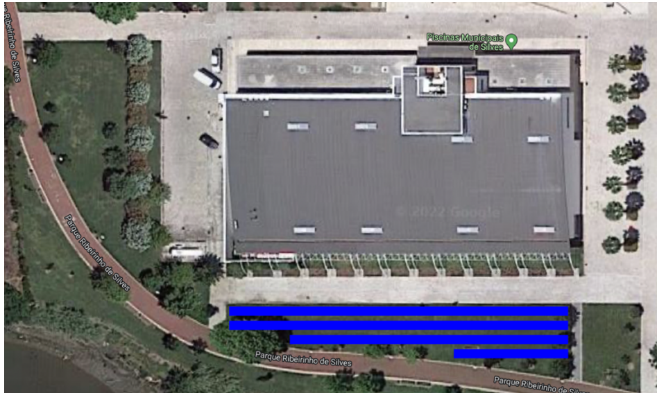
Figura 6.1 - Local de instalação do Sistema Solar Fotovoltaico (Fonte: Google Maps - Adaptação)
