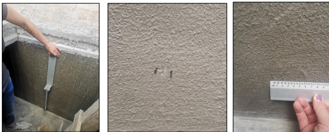
Figura 73 Início do ensaio (esquerdo) marcação do diâmetro da mocha (médio) medição do diâmetro da mocha (direita) Ensaio de choque de esfera – Tanque secundário
