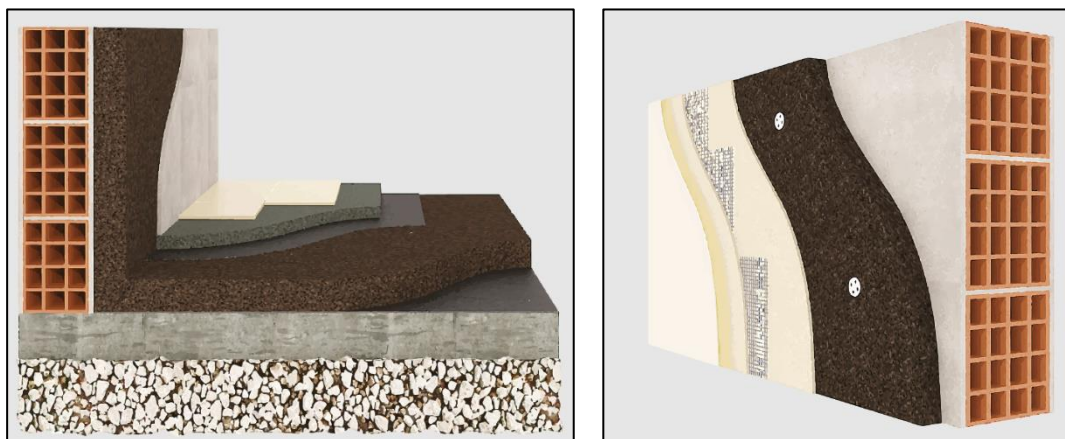
Figura 12 Isolamento com placas de ICB em pavimentos (esquerda) e fachadas (direita) (Sofalca, 2012)
