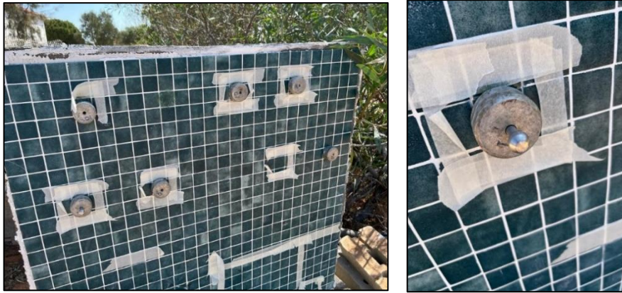
Figura 90 Amostras coladas (Esquerda), início do ensaio (Direita) na parede experimental 2 – mal colada
