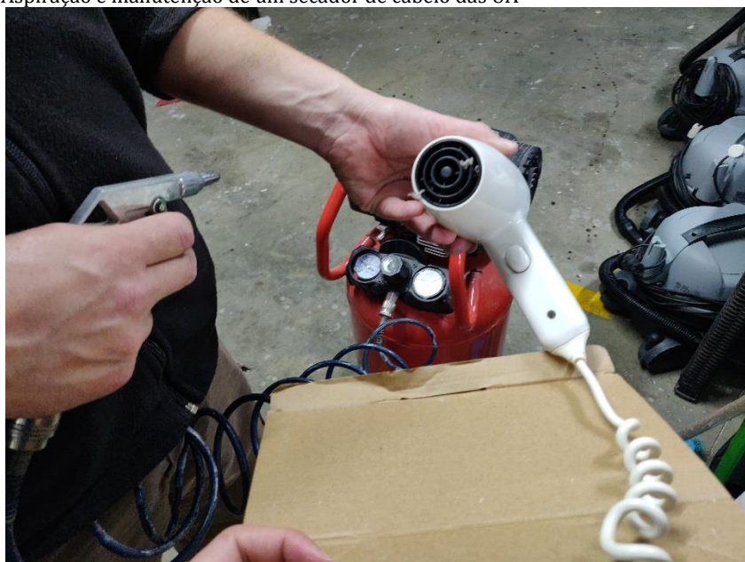
Figura 3.15 – Aspiração e manutenção de um secador de cabelo das UA
