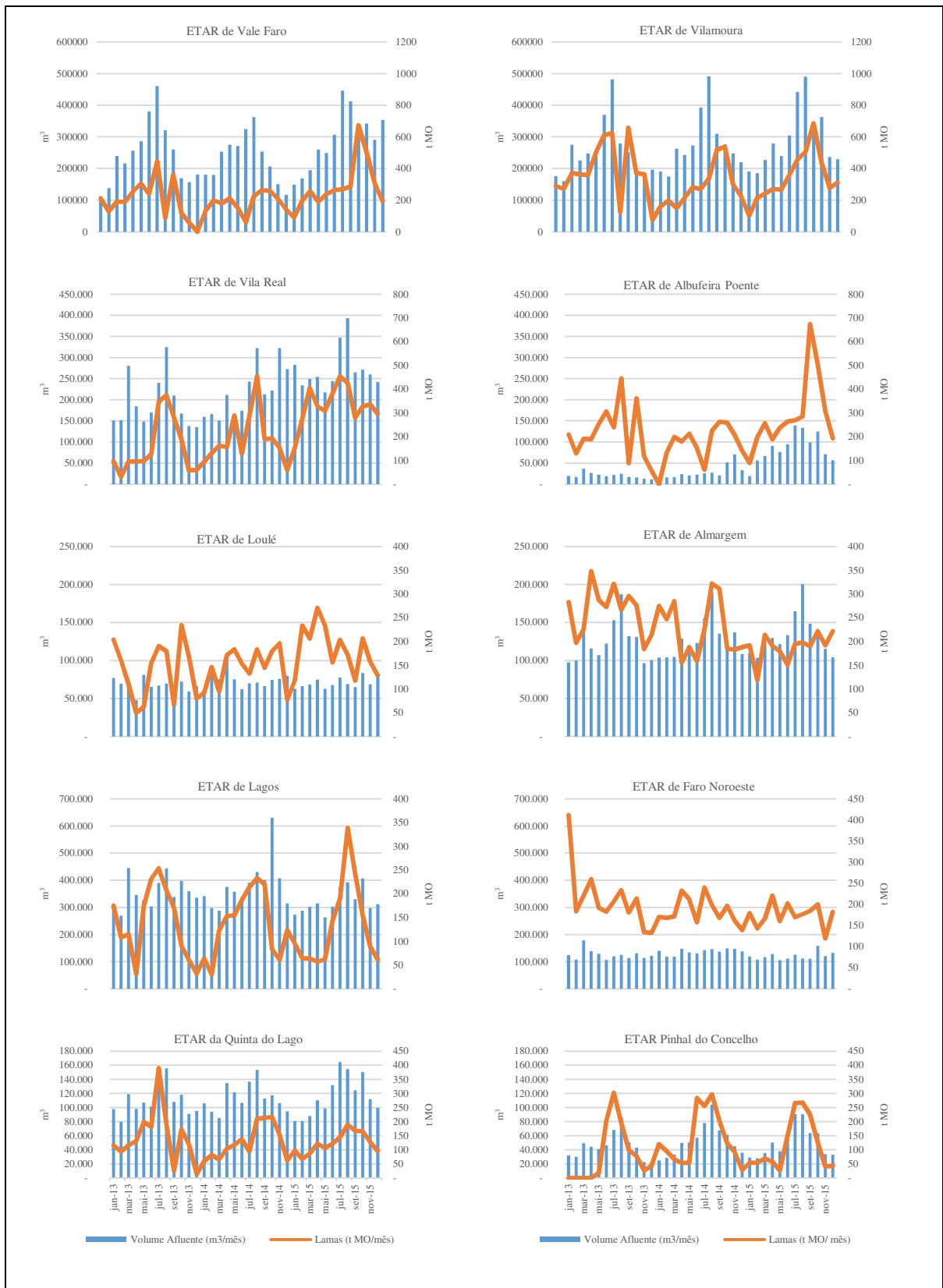
Figura 4.5 - Relação entre a produção de lamas e os caudais afluentes pelas 11 principais instalações produtoras de lamas da AdA
