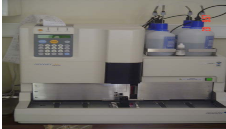
Figura II.3 – Analisador automático de hemoglobina glicada A1c, Cromatógrafo ADAMStm A1c HA-8160 da Menarini.
