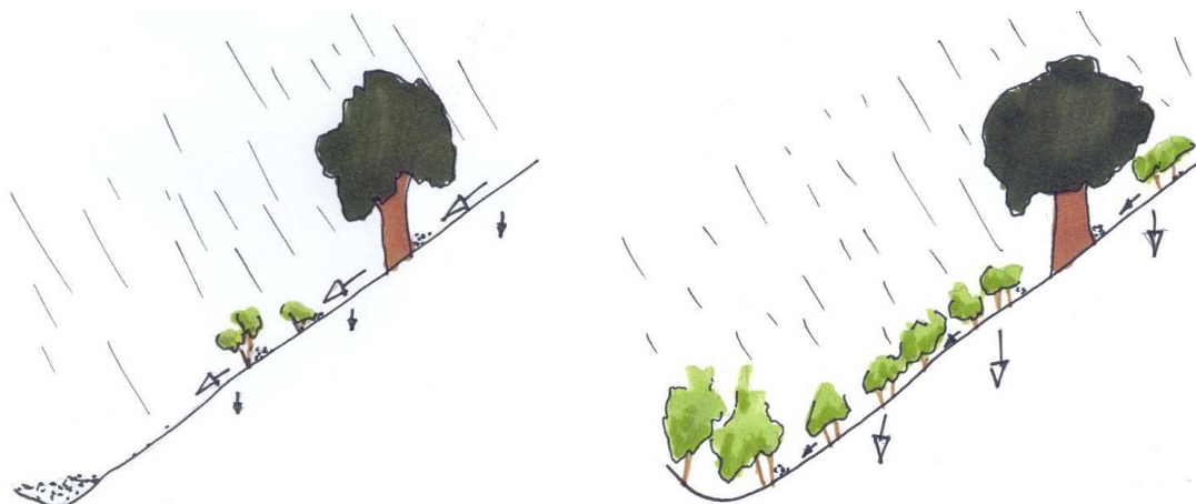
Figura 3 - Ilustração dos efeitos da erosão por drenagem superficial, sem sobcoberto (à esquerda), resultando maior escoamento superficial, conseqüente arrastamento de sedimentos e acumulação nas linhas de drenagem natural; e com sobcoberto (à direita), onde a camada de vegetação protege o solo, promovendo o aumento da infiltração e diminuição do escoamento superficial (Inês Duarte, 2007)
