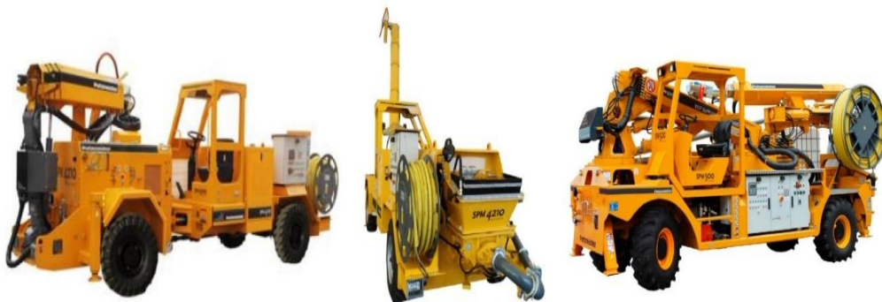
Figura 2. 3 – Robôs de projeção de betão. À esquerda, o modelo SPM 4210 Wetkret; ao centro, o modelo P 715 TD - SD; e à direita, o modelo SPM 500 Wetkret (putzmeister.com)
