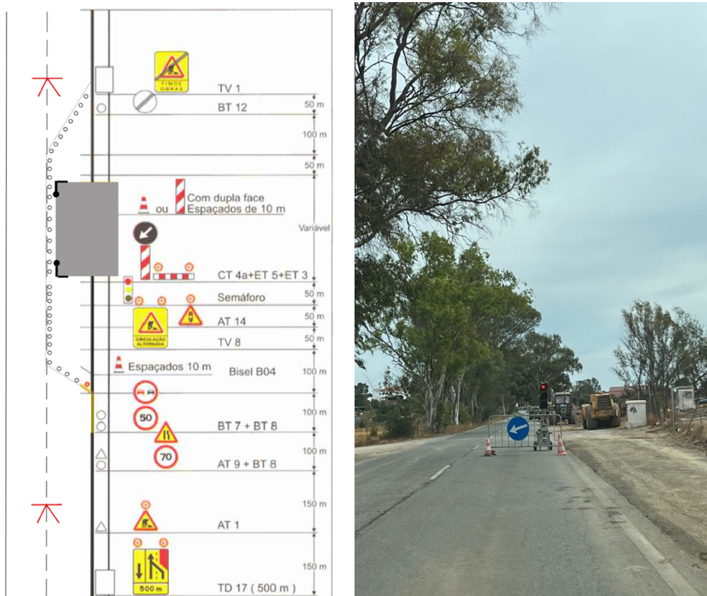
Figura 1 – Sinalização Temporária (esquerda) e Imagem no local da Sinalização Temporária, disponibilizado pela Empresa Landscape Office (2022).
