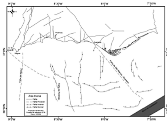
Figura 4.11. Mapa das falhas activas no intervalo de tempo Pliocénico-Quaternário na área imersa meridional da bacia do Algarve. A informação da área emersa foi retirada da fig. 4.8.
