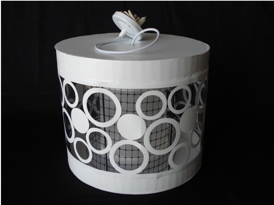
Figura 7: Modelo do electrocutor "Circuloluz". Sistema de electrocussão circular e candeeiro de tecto dos alunos Sara Vaz e Jorge Passos.
