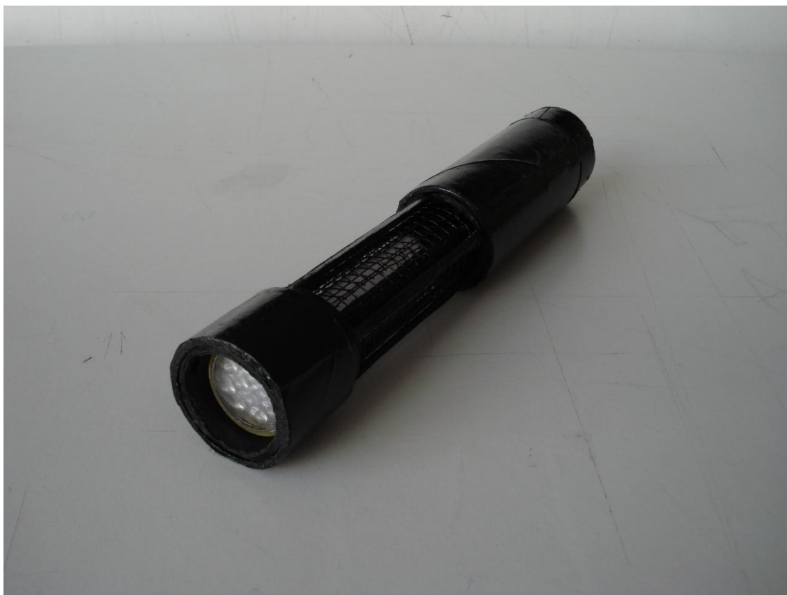
Figura 9: Modelo do electrocutor “LedChok”. Peça de iluminação e electrocussão de insectos portátil dos alunos Fátima Cerqueira e Luis Viana
