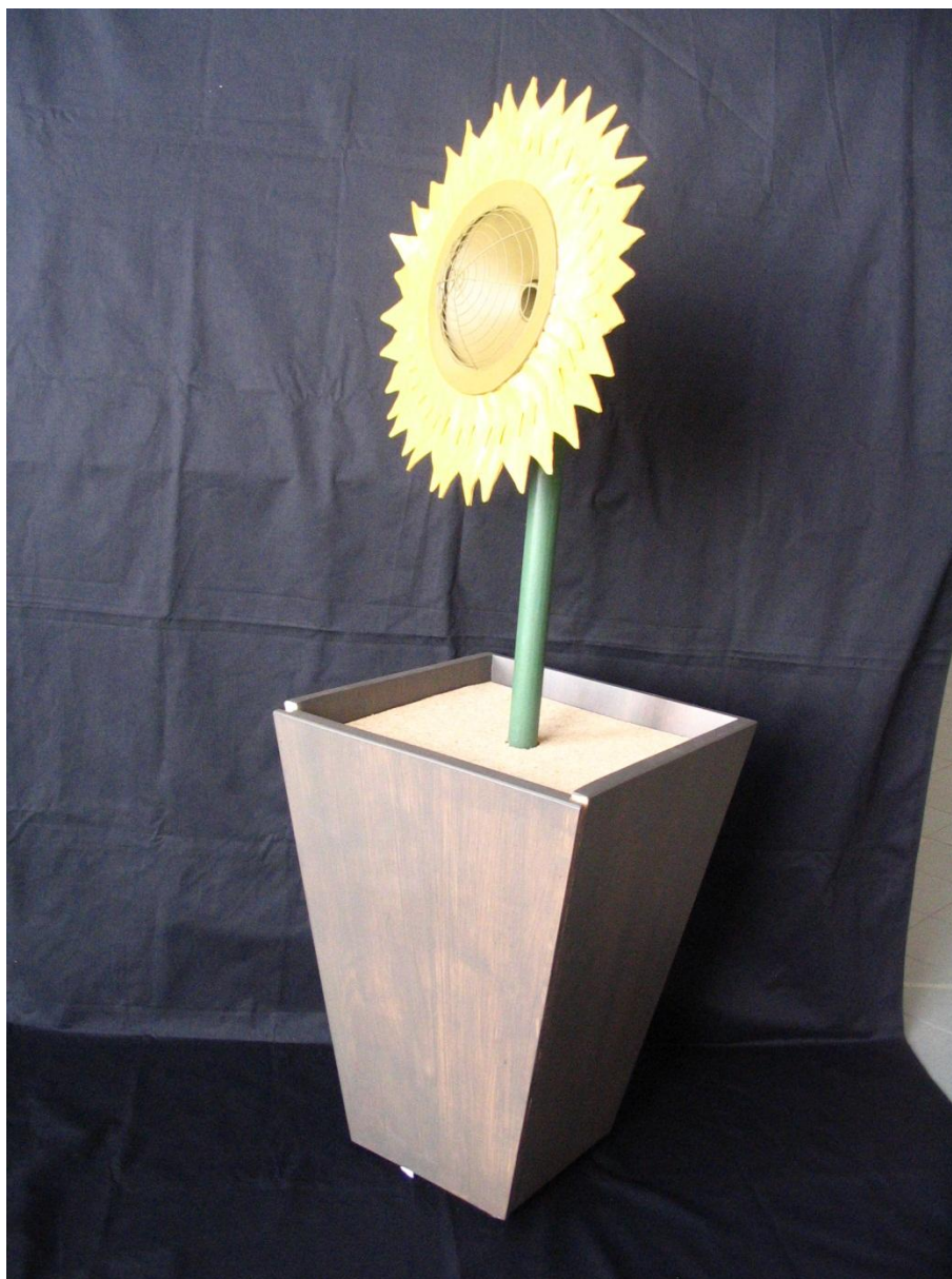
Figura 4: Modelo do electrocutor “Girassol”. Sistema de electrocussão de insectos recorrendo a elementos naturais para atrair insectos em ambiente doméstico.
