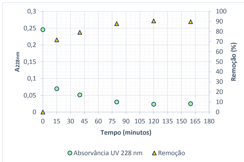
Figura 5.13 – Cinética de adsorção da solução de amoxicilina em água desionizada (10 mg/L) e respectivas remoções ao longo dos diferentes tempos de contato (300mg/L de PAC).
