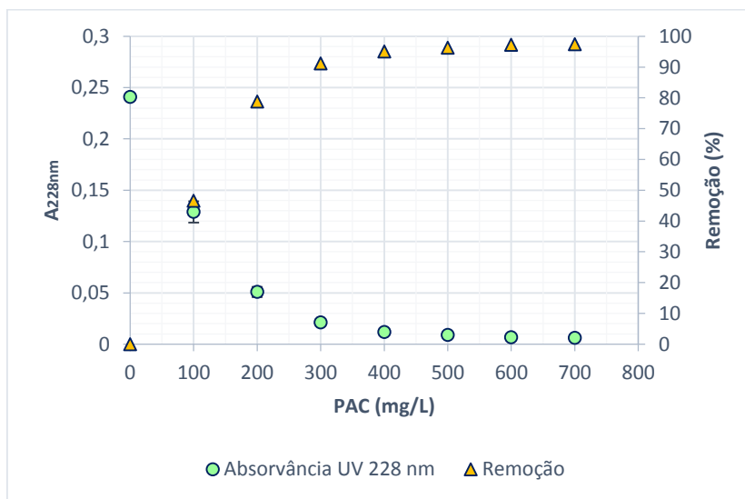
Figura 5.16 – Isotérmica de adsorção da solução de amoxicilina em água desionizada (10 mg/L) com a concentração de PAC e respetivas remoções.
