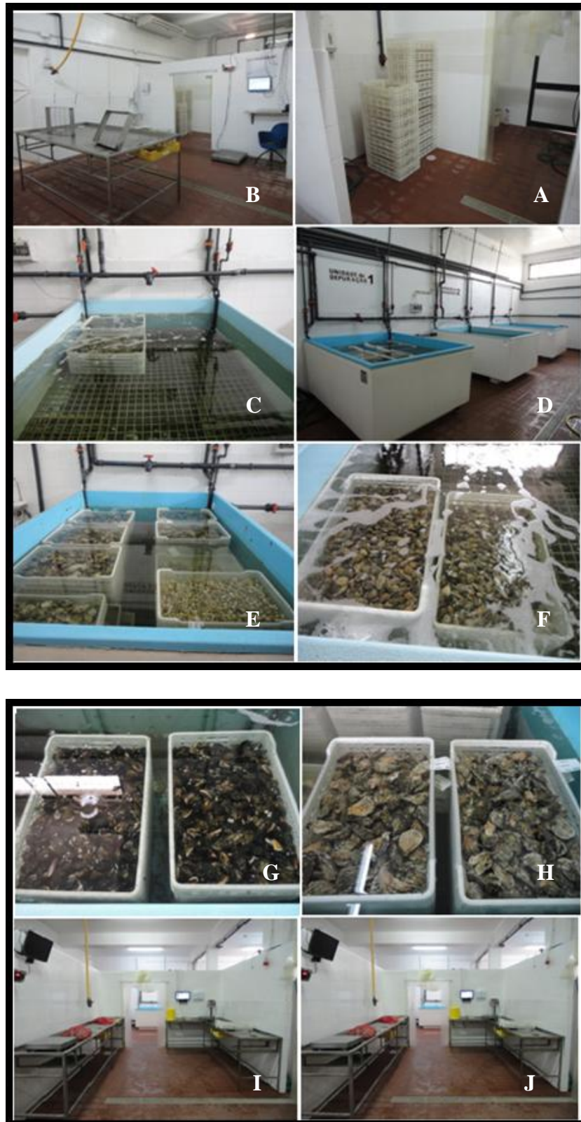
Figura 1.10: Imagens do centro de depuração e expedição da empresa PMA – Aquacultura Lda. ( A- Zona de recepção/Lavagem dos bivalves; B – Zona de escolha dos bivalves; C/D/F/G/H – tanques de depuração por espécies; Zona I/J – Zona de pesagem e embalagem).
