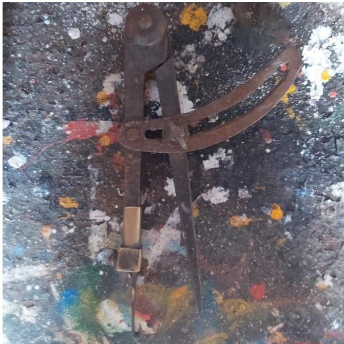
Figura 64- Compasso de marcar. Foto de autor. 2021
