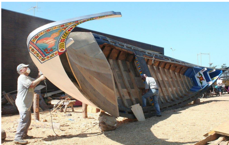
Figura 17- Construção de Barco Moliceiro. Museu-Estaleiro da Praia do Monte Branco. Fonte: Câmara Municipal da Murtosa (s/d).
