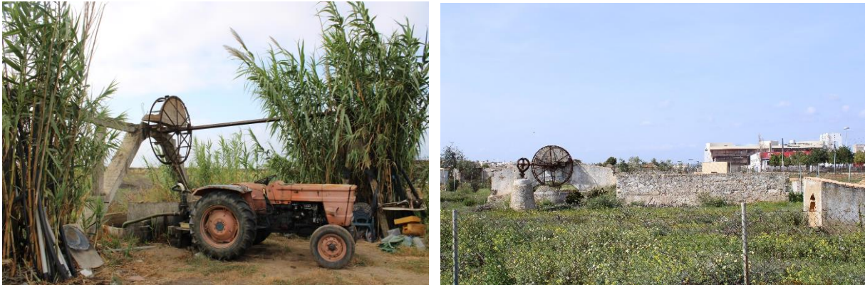
Figura 4.15 – À esquerda, nora moderna, com estrutura de betão armado; À direita, nora mais antiga, com estrutura em alvenaria de pedra (fotografias da autora).
