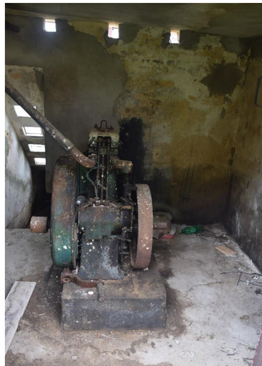
Figura 5.15 – À esquerda, a alteração da estrutura no centro do passeio do gado (fotografia de Desidério Batista); à direita, o motor a gasóleo com que se acionava a nora (fotografia da autora).
