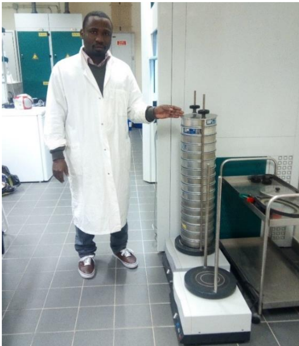
FIGURA 4.8. O presente autor na imagem mostrando a coluna de peneiros no agitador eletrônico, equipamento utilizado no Laboratório Sedimentologia, Universidade do Algarve, 2018)
