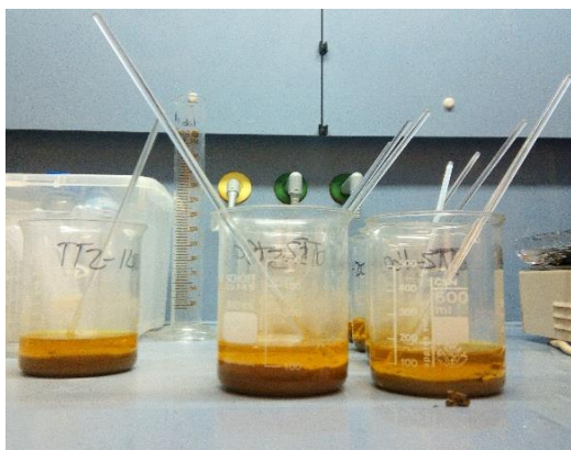
FIGURA 4.5. Copo de vidro de 600 ml com sedimento no processo de remoção de MO (Laboratório de Sedimentologia, Universidade do Algarve, 2018)
