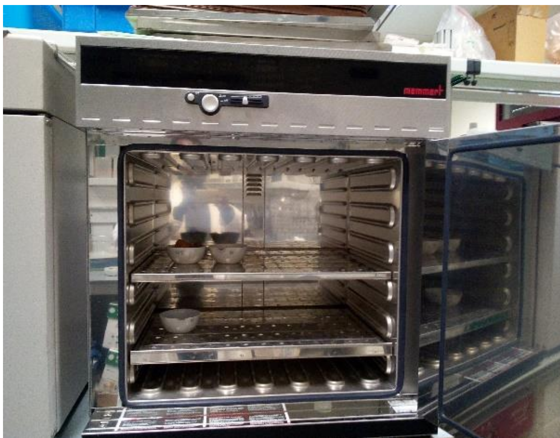
FIGURA 4.7. Estufa, o sedimento no processo de secagem na estufa, temperatura de 80°C (Laboratório de Sedimentologia, Universidade do Algarve, 2018)
