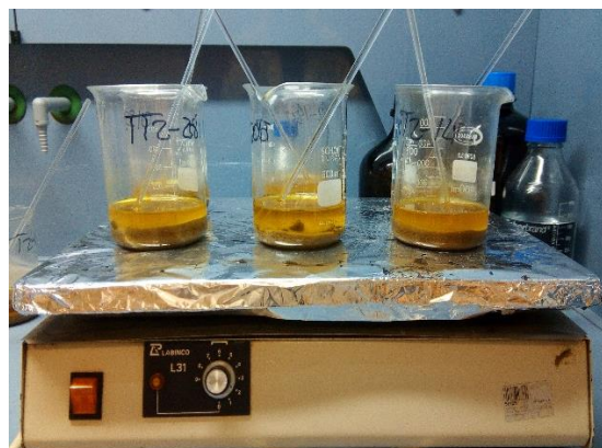
FIGURA 4.6. O sedimento no processo de remoção de MO na placa de aquecimento, equipamento que serve para acelerar o processo de oxidação de MO (Laboratório de Sedimentologia, Universidade do Algarve, 2018)
