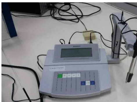
Figura 18. Medidor de pH para líquidos.
