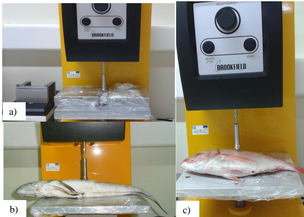
Figura 16. Imagem da medição da textura da a) amostra do tentáculo do polvo; b) pescada e c) cachucho.
