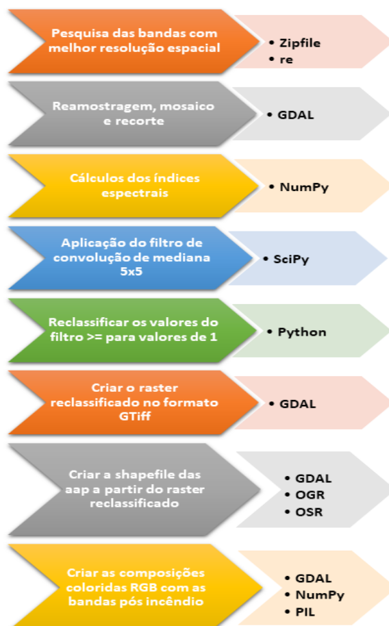
Figura 0.7. Fases do processamento das imagens Sentinel-2 com identificação das bibliotecas utilizadas
