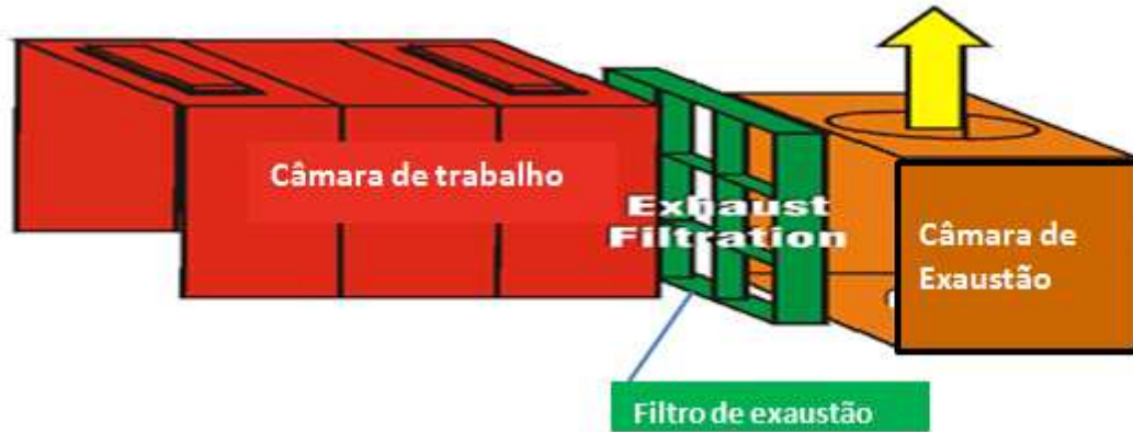
Ilustração 11 – Sequência de equipamentos exaustão
