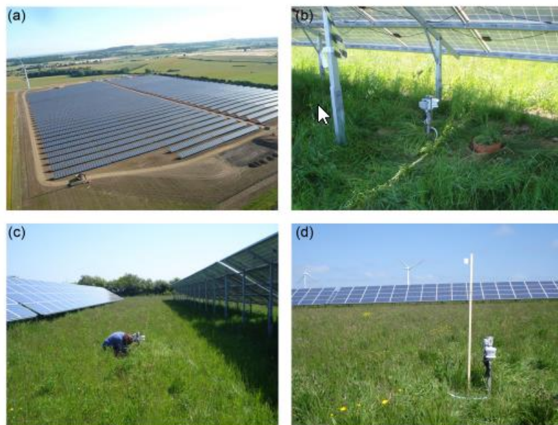
Figura 13. (a) vista aérea do parque (b) área de controle com sombreamento total (c) área de controle com sombreamento parcial (d) área de controle sem sombreamento (ARMSTRONG et al., 2016).
