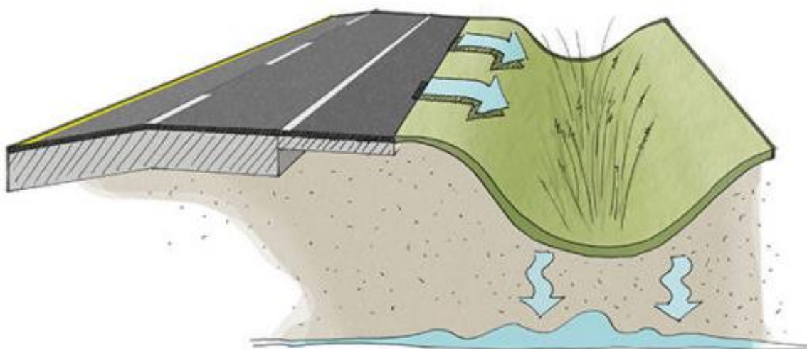
Figura III.12 - Esquema de uma biovaleta ( https://riversandinc.com/blog/view/what-is-a-bioswale/ )
