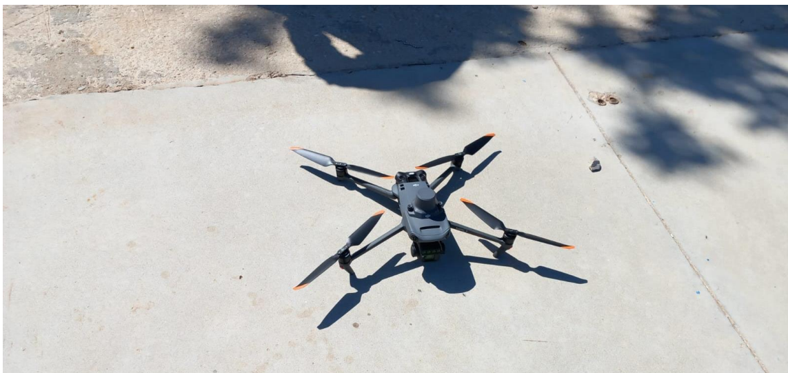
Figura I.13 - Drone Mavic 3 Enterprise DJI, utilizado na formação (Autor)
