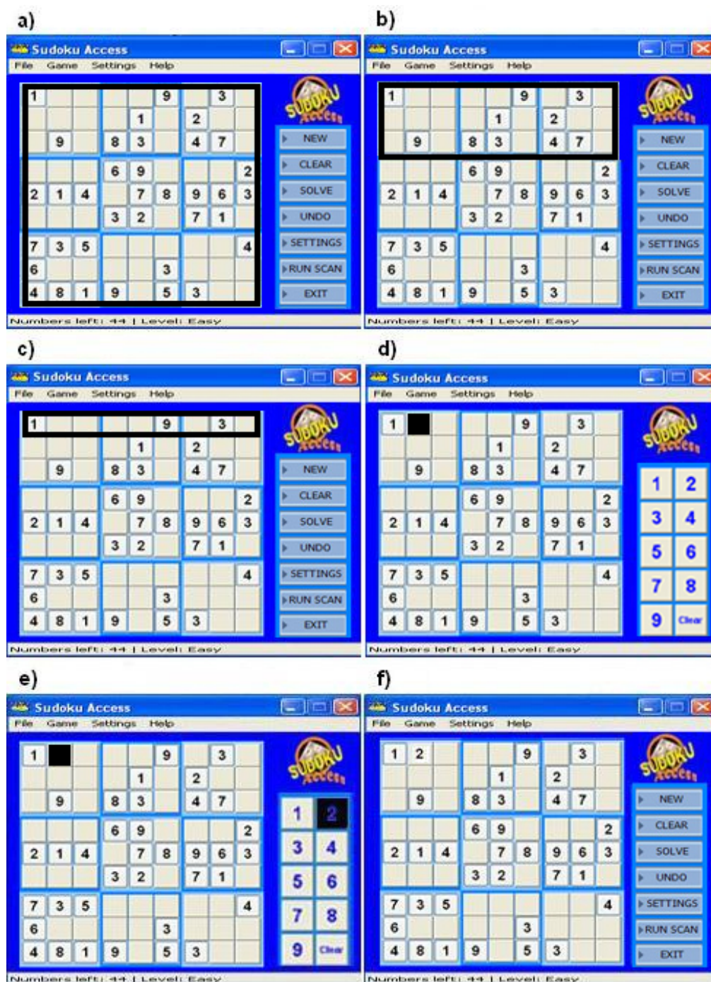
Figura 7.4: Sistema de selecção do jogo Sudoku Access . Este sistema de selecção permite ao utilizador preencher as células do puzzle com os números, utilizando um simples botão de toque ou pressionando a tecla “Espaço”. a) Selecção do primeiro grupo, b) selecção do primeiro subgrupo, c) selecção da primeira linha do primeiro subgrupo, d) selecção do primeiro item da primeira linha do primeiro subgrupo, e) um outro sistema de selecção é activado no teclado numérico (visualizado no lado direito do puzzle), sendo que nesta fase o próximo “click” corresponde à escolha do número desejado, f) o número desejado é enviado à célula.
