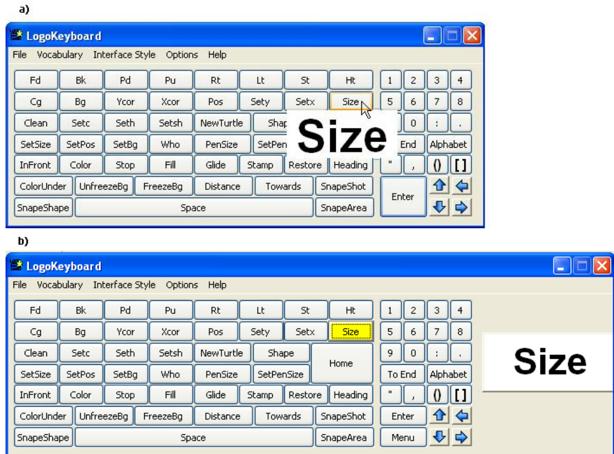
Figura 6.5: O sistema para aumentar o tamanho das teclas no teclado virtual pode ser manipulado de duas formas: a) colocando o cursor do rato na tecla desejada ou b) automaticamente através do sistema de varrimento.
