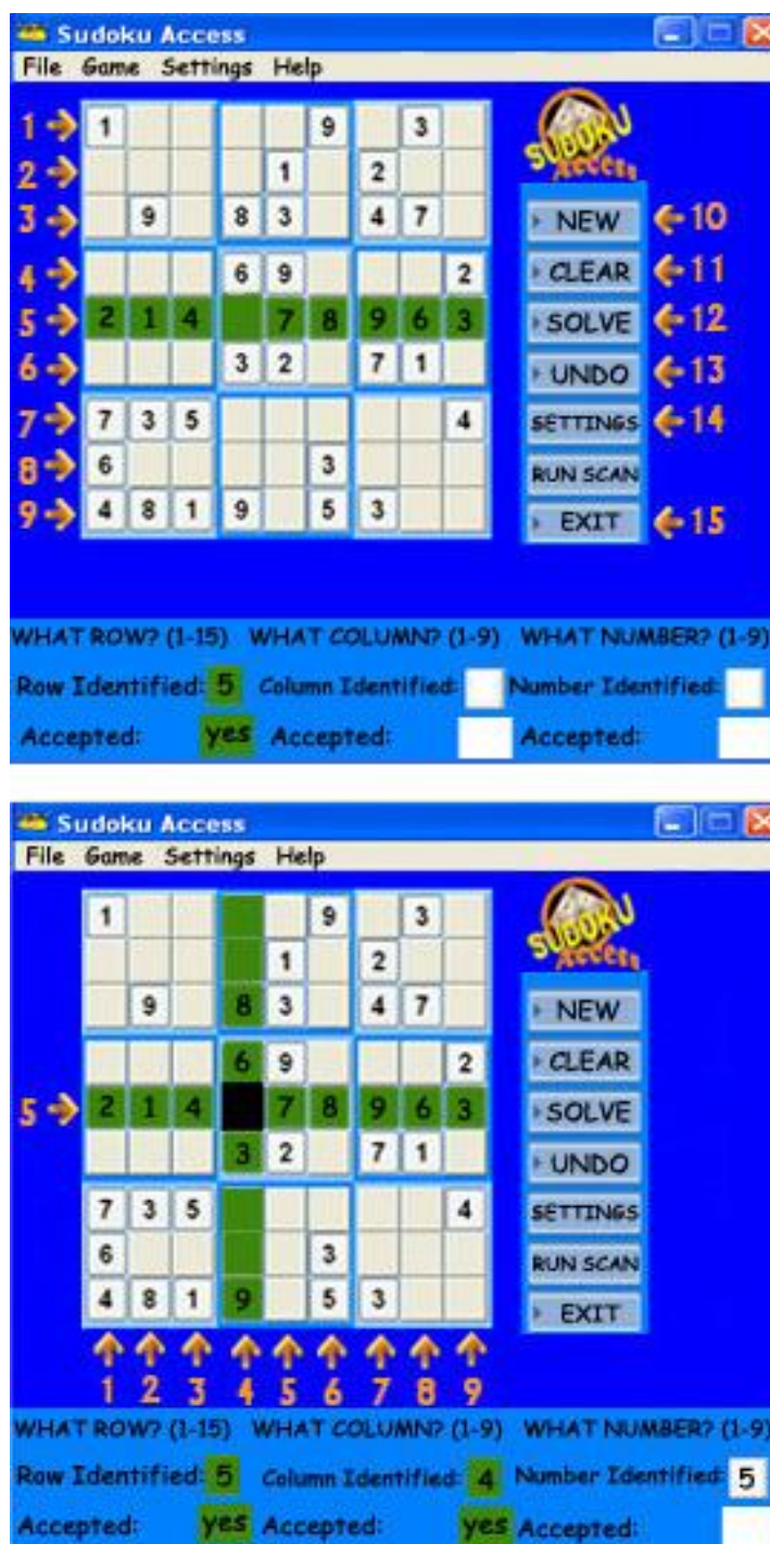
Figura 7.5: O sistema de reconhecimento de voz como processo de selecção no jogo Sudoku Access . Utilizando a voz, o utilizador escolhe números entre 1 e 5 para escolher a tarefa desejada. Neste exemplo o utilizador escolheu o número “4” que corresponde à activação do sistema de treino do reconhecimento de voz da Microsoft.
