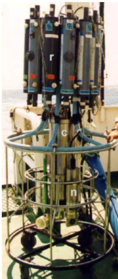
Figura III-1. Fotografia do conjunto CTD+rosette. r = rosette com as 12 garrafas tipo Niskin; c = CTD; n = nefelómetro.
