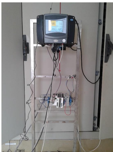
Figura 2.1- Sistema de controlo com autómato e display .
